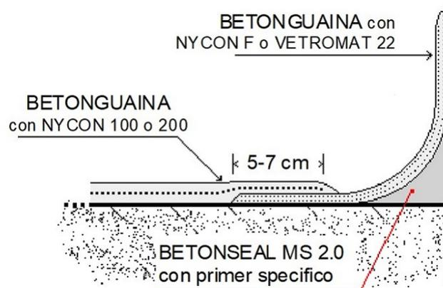
Figura 10 - Impermeabilizzazione di risvolti verticali e superficie piana.
