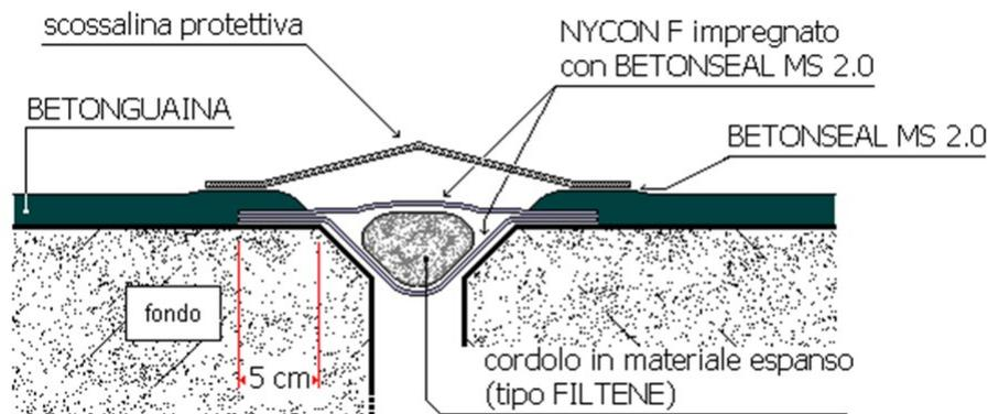
Figura 9 - Realizzazione di giunti di dilatazione strutturali.
