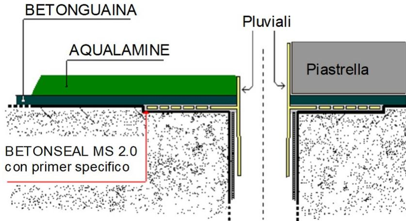
Figura 8 - Preparazione e posa dei pluviali.
