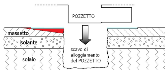
Fig. 3b: schema finale di montaggio del pozzetto nell'alloggiamento
