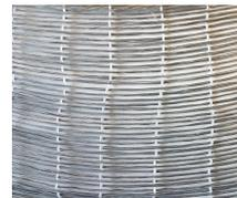
Tessuto unidirezionale in fibra di acciaio galvanizzato per interventi strutturali in sistemi S-FRCM
